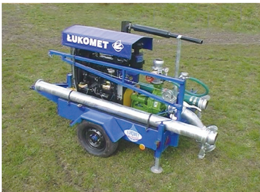
Ryc. 19. Spalinowy agregat pompowy (fot. Łukomet)
