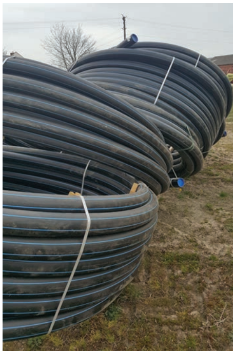
Ryc. 21. Deszczowniane węże przesyłowe PE (fot. R. Rolbiecki)
