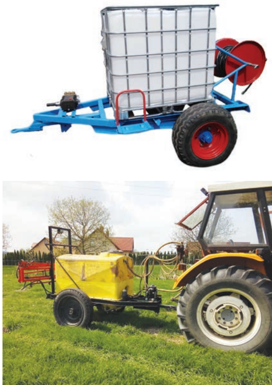
Ryc. 40. Prototyp urządzenia do płukania rurociągów drenarskich (Kaczanowski 2021)
