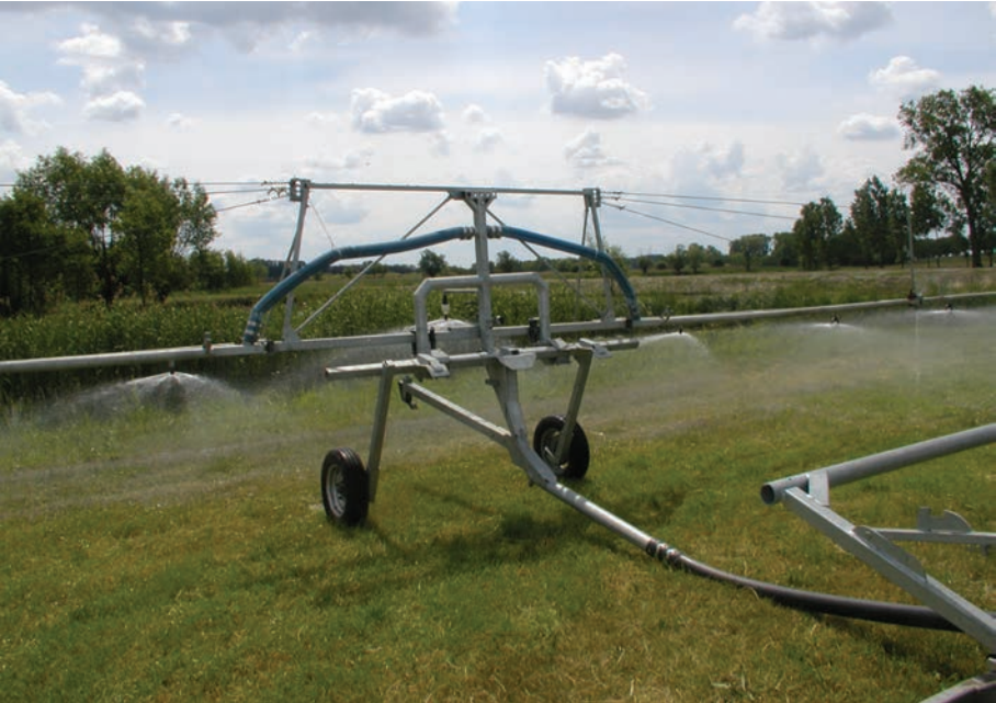
Ryc. 26. Deszczownia szpulowa (bębnowa) zakończona konsolą w czasie pracy (fot. R. Rolbiecki)
