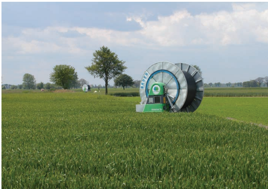
Ryc. 24. Deszczownia szpulowa (bębnowa) ( fot. R. Rolbiecki)
