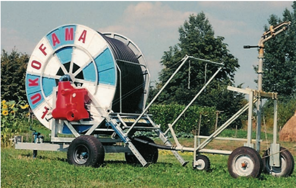
Ryc. 23. Deszczownia szpulowa (bębnowa) zakończona zraszaczem (fot. Łukomet)
